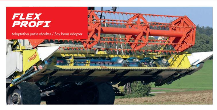
La FLEX PROFI est de loin la variante la plus avantageuse pour la récolte sans perte de soja,pois,etc... Grâce à sa barre de coupe flexible jusqu'à 15cm de débattement en hauteur, elle ramasse sans problème les variétés les plus basse, même sur les terrains accidentés, ce qui peut entraîner un rendement supplémentaire de 200-250kg par hectare.
